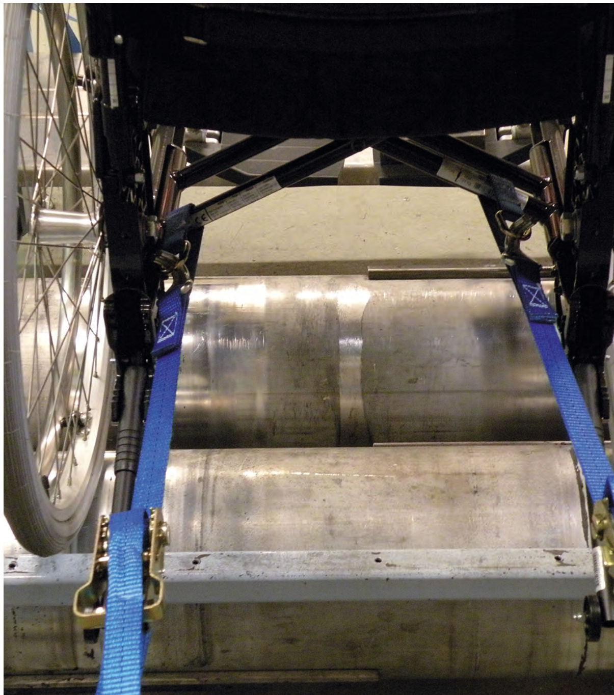
Rullstolar utsattes för tvåhundrausen cykler i den här dubbeltrummaskinen.
