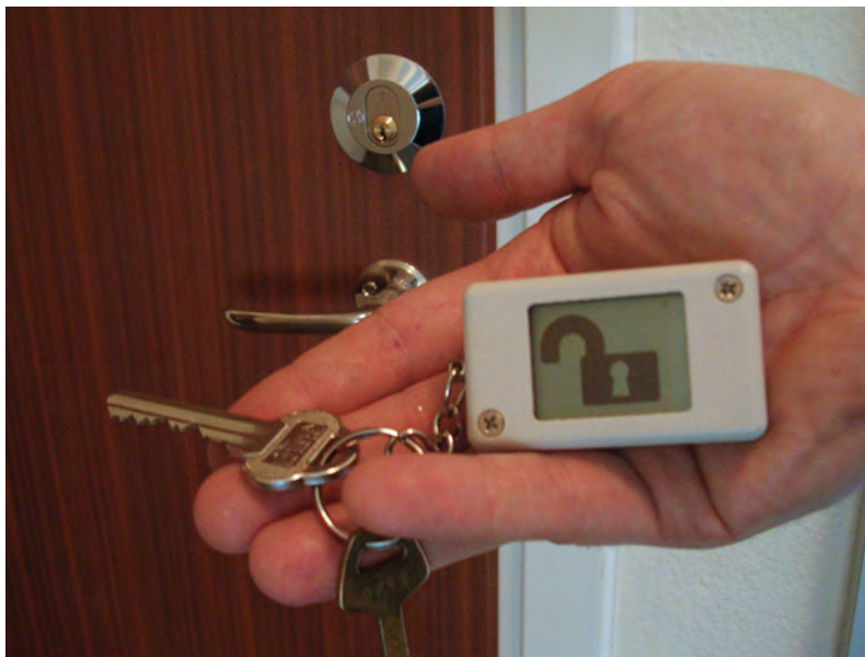
Nyckelbrickan har en display som visar om dörren är låst.
